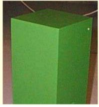
"Zylinder" aus verleimten Sperrholzplatten entschieden (Bild 4). Mit den Abmessungen 120x120x400 mm reicht dieses Gebilde etwa bis zur Mitte in die Antennenschleife hinein. Dieses an den Innenkanten mit Leisten 5x5 mm verstärkte Holzgehäuse wurde mehrmals mit Porenfüller vorbehandelt und dann dreimal mit dunkelgrünem Acryllack gestrichen. Den gleichen dunkelgrünen Anstrich erhielt auch die Antennenschleife, um sie gegenüber umstehenden Bäumen zur Tarnung anzupassen.
